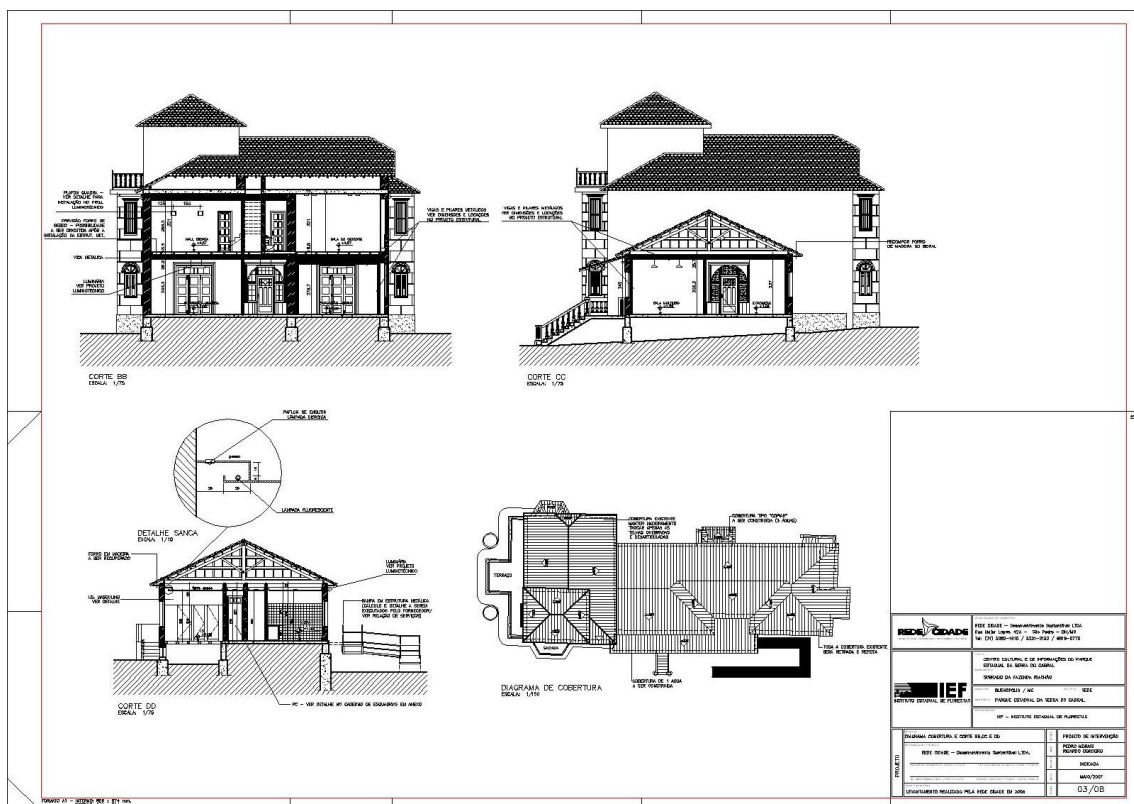
Fig. 04: Reprodução Projeto Intervenção. Seções Verticais Transversais e Planta de Cobertura. Fonte: IEF, 2007.
